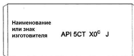
Маркировка клеймением - необязательная ПРИМЕЧАНИЕ Маркировка клеймением по середине муфты наносится в продольном или поперечном направлении.
